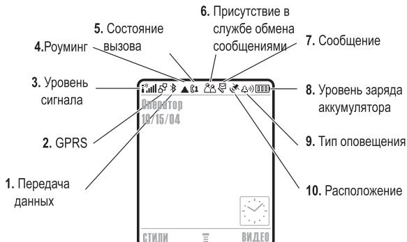
**1. Индикатор передачи данных-** показывает состояние соединения и передачи данных. Индикатор беспроводной связи Bluetooth® ☺ показывает активность соединения Bluetooth. Другие индикаторы:
