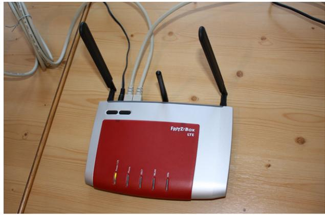
Сообщается об LTE/Wi-Fi роутере AVM Fritz!Box 7270 на базе чипсета Altair Semiconductor (на базе чипов FourGee 3100 и 6200). Данное устройство производит компания AVM. Поддерживаемые диапазоны 800 и 2600 МГц.
