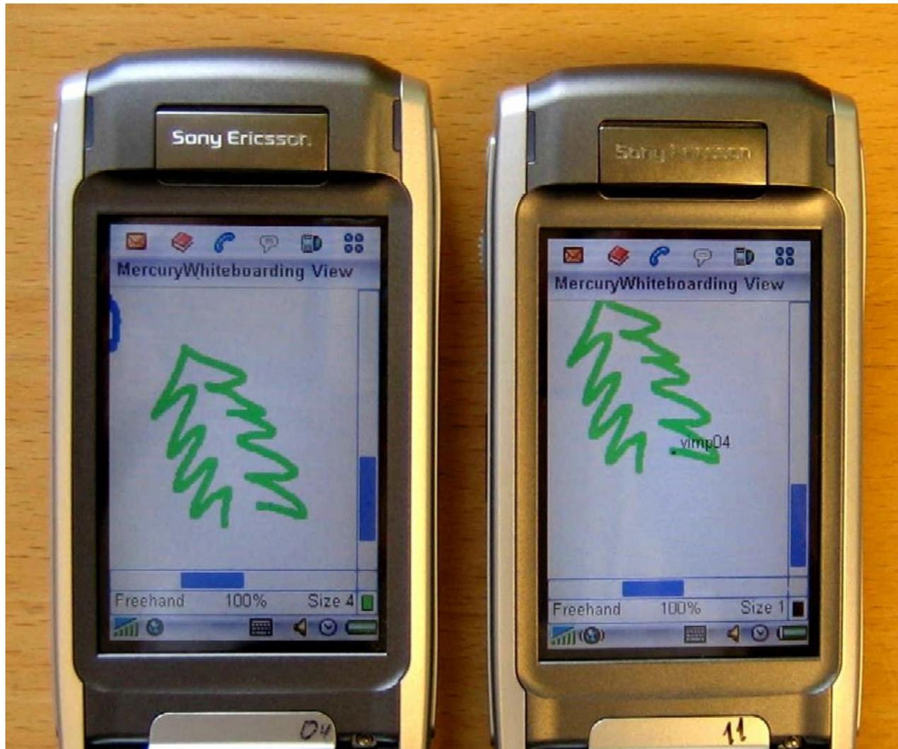
Два терминала с установленными на них приложением «Whiteboard» работающими на базе системы IMS обеспечивают абонентам возможность создавать и редактировать файлы - например, картинку в режиме on-line.
