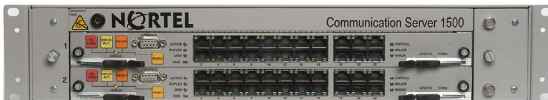
Рисунок 3. CS1500i Core Module (2 Core Controllers)
